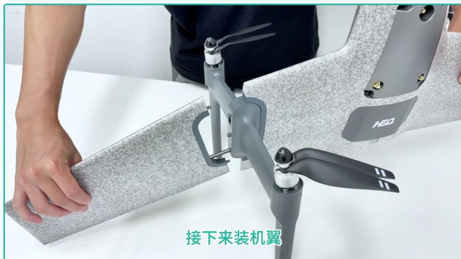
步骤 3 | 安装第一片机翼
